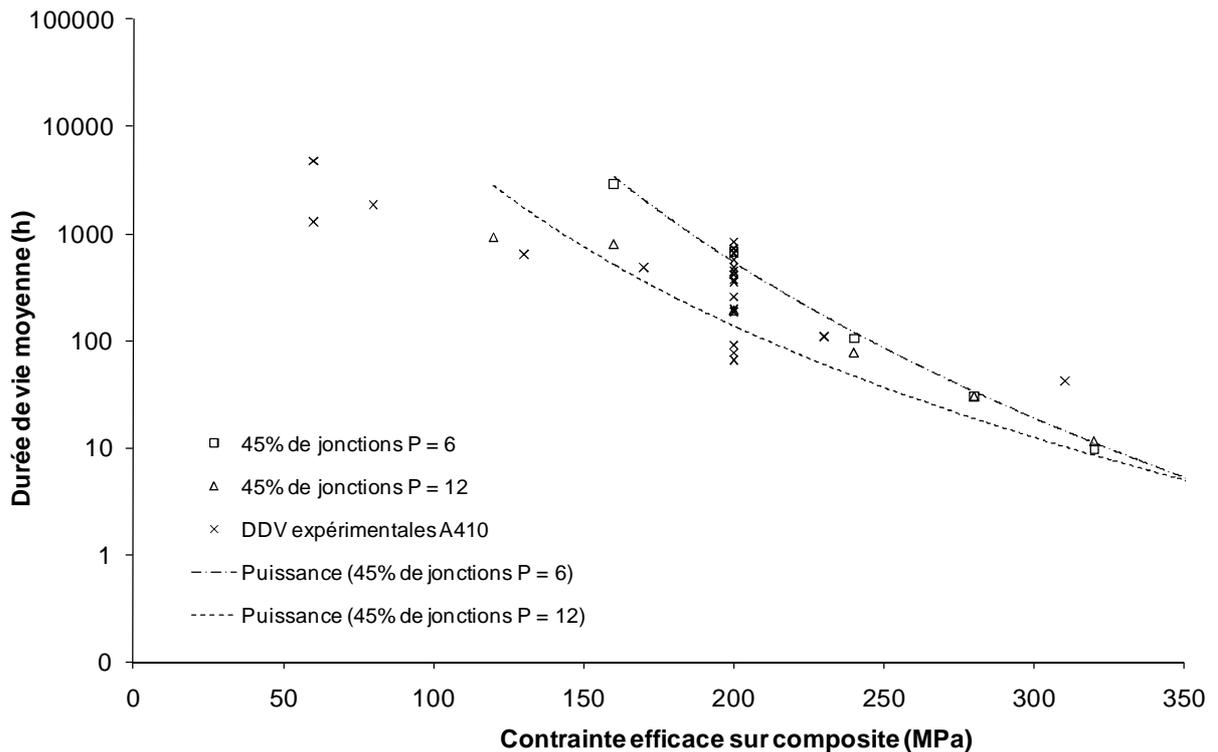
**Figure IV – 18** Effet de la taille des paquets de fibres sur la durée de vie du composite pour un taux de fibres jointives de 45%. Fatigue statique à 500°C sous air ambiant. P désigne la taille de paquet (6 et 12 fibres). La durée de vie diminue lorsque la taille de paquet augmente.
