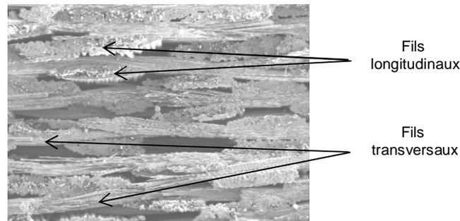
**Figure II – 3** Micrographie d'un faciès de rupture du composite. Mise en évidence de l'hétérogénéité importante de la microstructure.
