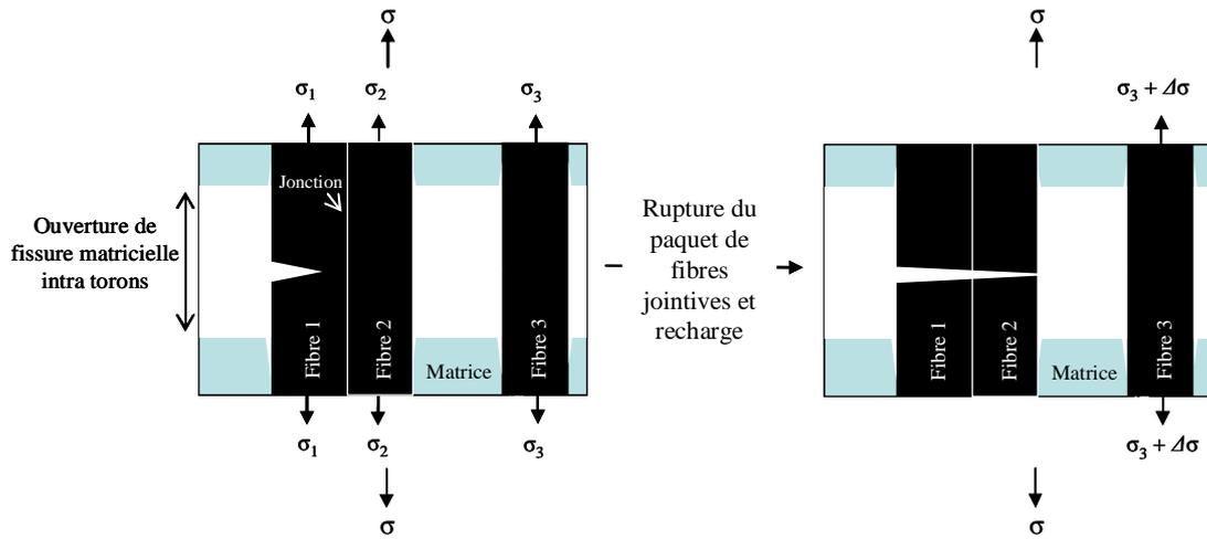
**Figure III – 24 Schématisation de la propagation de fissure de proche en proche entre les fibres via les jonctions. La fissure dans la fibre se propage dans la fibre 2 via la jonction. La rupture du paquet (fibre 1 + fibre 2 ) engendre la recharge des fibres non rompues (fibre 3) au sein des fils longitudinaux au cours de la fatigue statique. La rupture de la fibre 1 suffit pour éliminer la fibre 2.**
