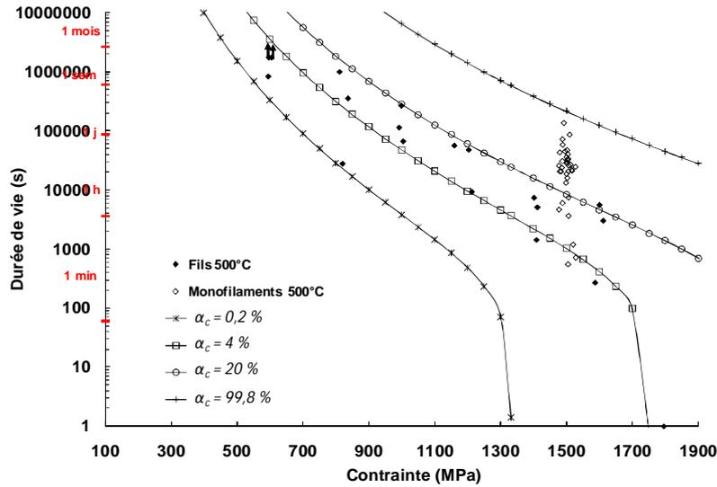
Figure I – 33 Prévisions de la durée de vie sur fibre et fil Hi-Nicalon à partir du modèle de fissuration sous critique et pour différentes valeurs de  $\alpha_c$ . Comparaison des prévisions aux durées de vie obtenues par les essais de fatigue statique à 500°C [Gauthier2008].
