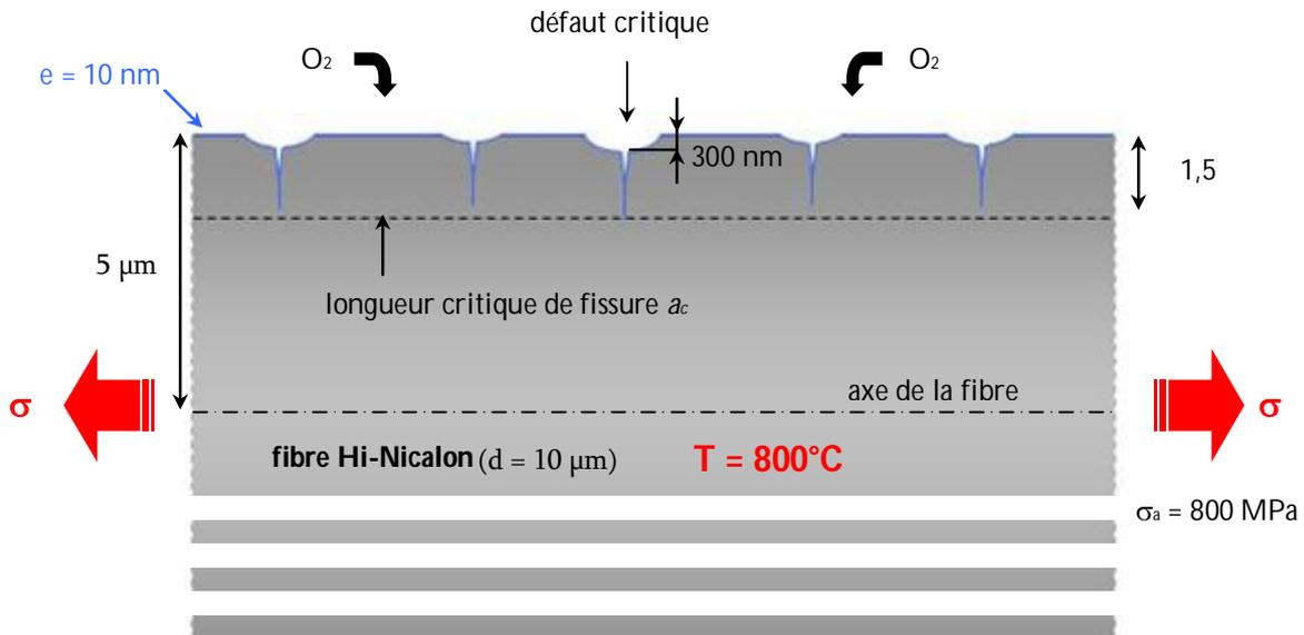
**Figure I – 21** Description des processus d'oxydation au sein d'une fibre : coexistence de la fissuration sous critique et d'une l'oxydation superficielle <sup>[Gauthier2007]</sup>. Réduction de diamètre négligeable par oxydation superficielle (300nm) par rapport à la fissuration sous critique de défaut (1,5μm).
