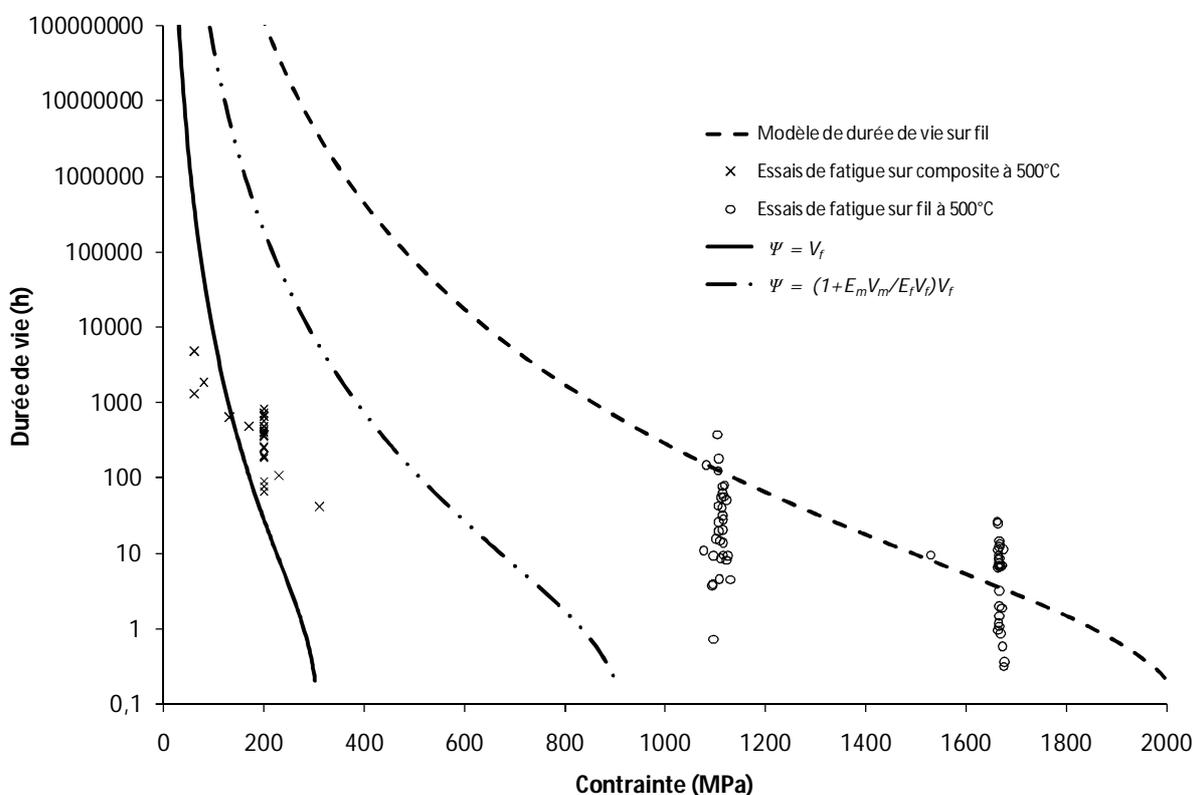
Figure II – 21 Prédiction des durées de vie moyennes (50%) sur composite à partir de l'opérateur  $\Psi$  et du modèle de durée de vie sur fil. Fatigue statique à 500°C sous air ambiant. Bonne corrélation entre les prévisions et les durées de vie expérimentales sur composite.
