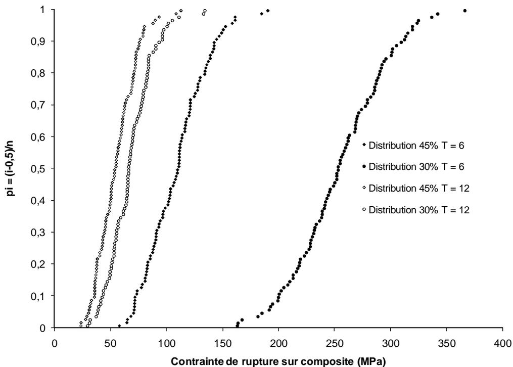
**Figure IV – 24 Effet de la taille de paquet sur la contrainte de rupture du composite en traction monotone à l'ambiante. 2 taux de fibres jointives (30% et 45%) et 2 tailles maximales de paquets sont étudiés (6 fibres et 12 fibres). Lorsque la taille de paquet augmente, les courbes de dispersion tendent à se superposer indépendamment du taux de fibres jointives. La taille de paquet semble prédominer sur le taux de fibres jointives.**
