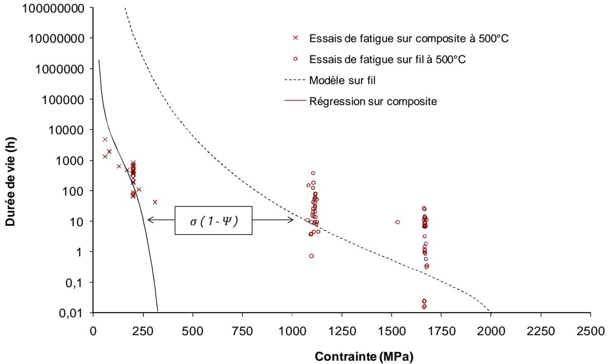
**Figure II – 20** Identification de l'opérateur de changement d'échelle  $\Psi$ . Pour chaque valeur de durée de vie  $t$ ,  $\Psi$  est calculé à partir de  $\sigma|_{t_r} - \sigma_c|_{t_r}$ . Pour le composite, la contrainte correspond à la contrainte efficace. Pour le fil, la contrainte est la contrainte sur fil.
