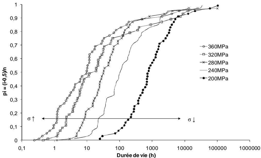
**Figure IV – 11 Décalage de la distribution des durées de vie du fil longitudinal vers les faibles valeurs sous l’effet de l’augmentation de la contrainte efficace. Résultats obtenus par le modèle en fatigue statique en traction, à 500°C, 200MPa sous air ambiant. Taux de fibres jointives de 45%, la microstructure est identique pour toutes les simulations.**
