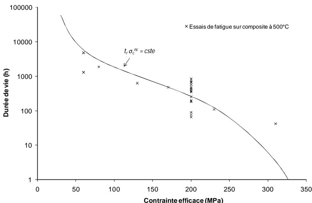
**Figure II – 17** Courbe d'endurance obtenue par régression numérique sur les durées de vie expérimentales à 500°C sous air ambiant du composite en fonction de la contrainte. Identification de (Eq. II – 10).
