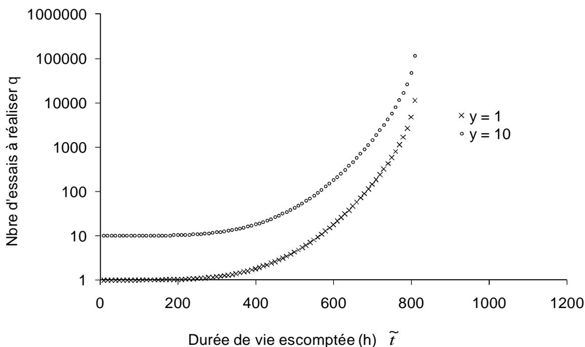
**Figure V – 17 Evolution du nombre d'essais à réaliser  $q$  en fonction de  $\tilde{t}$  pour 2 valeurs de  $y$ . Composite SiC/SiC A410 en fatigue statique à 500°C sous air ambiant à 200MPa. Pour obtenir 10 durées de vie d'au moins 600 heures, il faut réaliser au moins 150 essais.**
