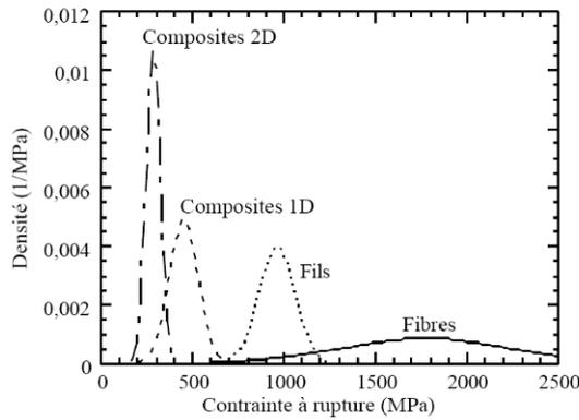
**Figure I – 14 Distributions statistiques des contraintes de rupture de monofilament, de fil de carbure de silicium (fibres Nicalon NLM 202), de composites SiC/SiC à renfort unidirectionnel (minicomposites) et à renfort tissé [Lamon2005]. Mise en évidence de la troncation à chaque changement d'échelle.**
