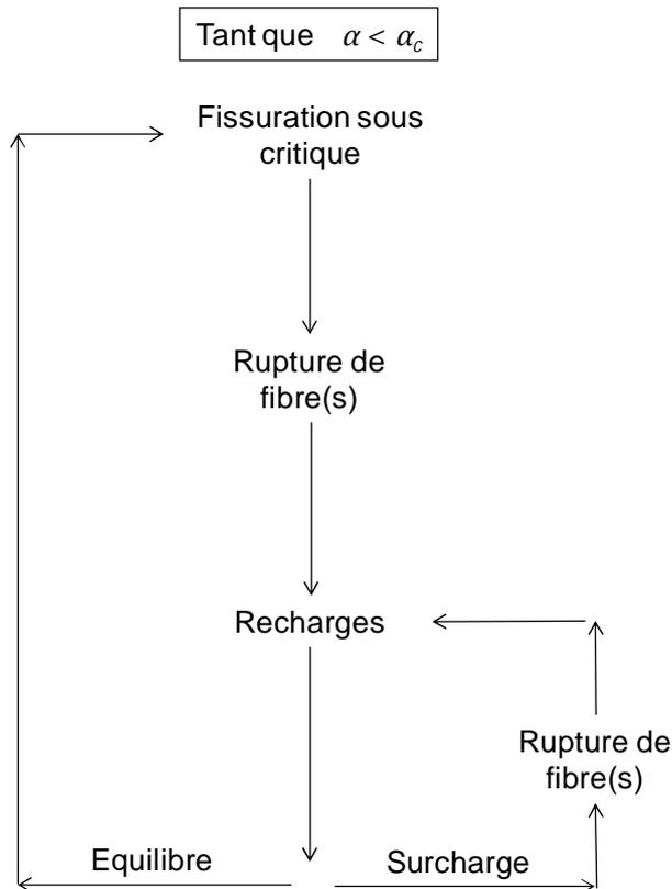
**Figure III – 26 Schématisation de la cinétique d'endommagement du composite en fatigue. Mise en évidence de la chronologie des mécanismes d'endommagement. Le premier mécanisme est la fissuration sous critique qui est le processus pilote.**
