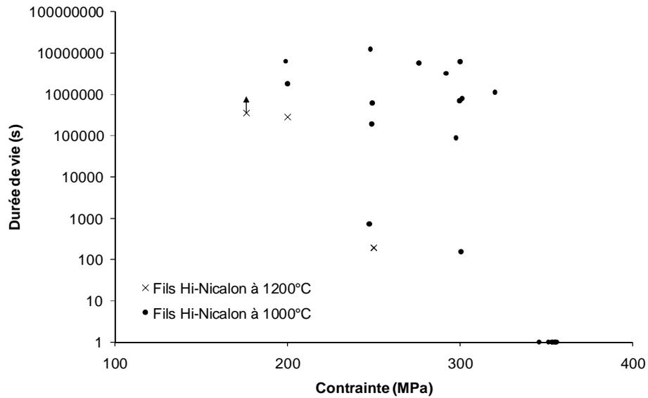
Figure I – 28 Diagramme d'endurance démontrant la rupture différée en fatigue statique des fils Hi-Nicalon à 1000°C et 1200°C. Mise en évidence de la dispersion significative de la durée de vie [Laforet2009].
