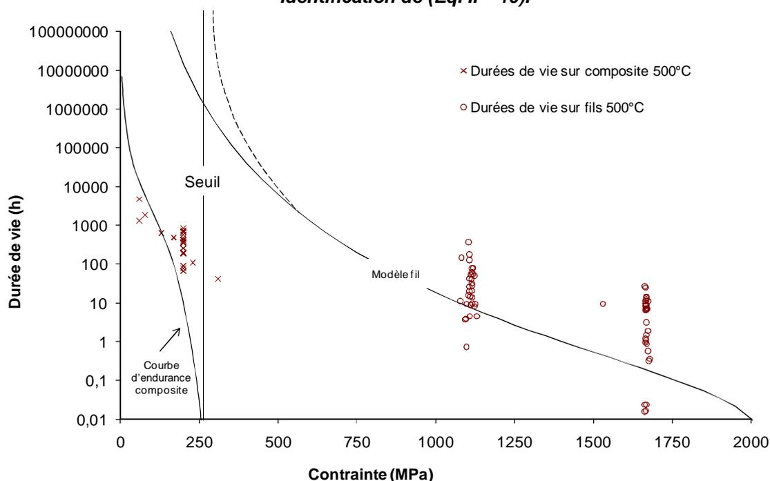
**Figure II – 18** Diagramme des durées de vie en fonction de la contrainte. Fatigue statique à 500°C sous air ambiant sur composite et fil [Laforet2009]. Evolution du facteur  $n$  de la loi puissance lors du passage entre le fil ( $n_f = 8$ ) et le composite ( $n_c = 2$ ). Mise en évidence d'une contrainte seuil pour les fils. Pas de correction de contrainte : contrainte efficace pour le composite et contrainte sur fil pour les fils.
