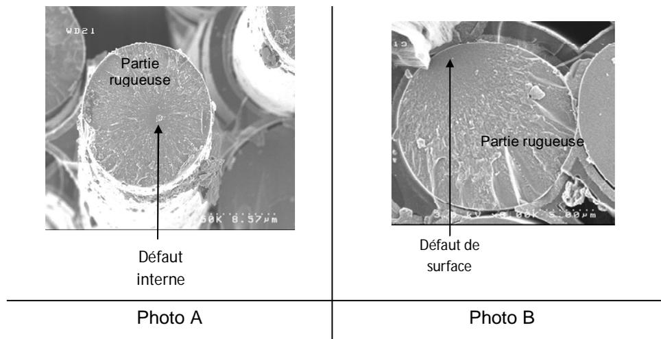
**Figure III – 12 Microscopie illustrant la morphologie des miroirs. Photo A : la rupture de la fibre est amorcée par un défaut interne. Photo B : la rupture de la fibre se produit à partir d'un défaut de surface.**
