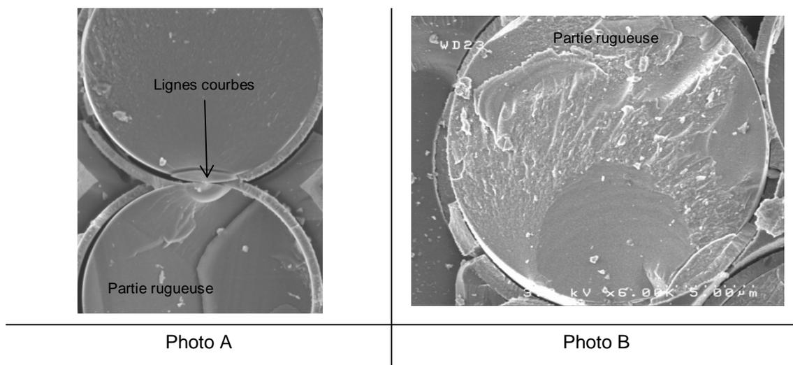
**Figure III – 5** Illustration de la difficulté pour discriminer un faciès miroir et un faciès de fissuration sous critique. Photo A : la fibre du bas semble être un miroir par la présence d'une partie rugueuse. Pourtant des lignes courbes s'apparentent à des fronts d'avancée de fissure au niveau du contact entre les fibres. Photo B : faciès qui présente des fronts d'avancée de fissure typiques d'une fissuration sous critique et une zone rugueuse typique des miroirs.
