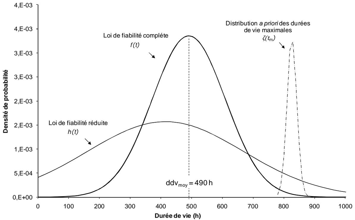
Figure V – 5 Représentation des lois des durées de vie et des durées de vie maximales pour un composite en fatigue statique à 500°C – 200MPa sous air ambiant en traction uniaxiale.
