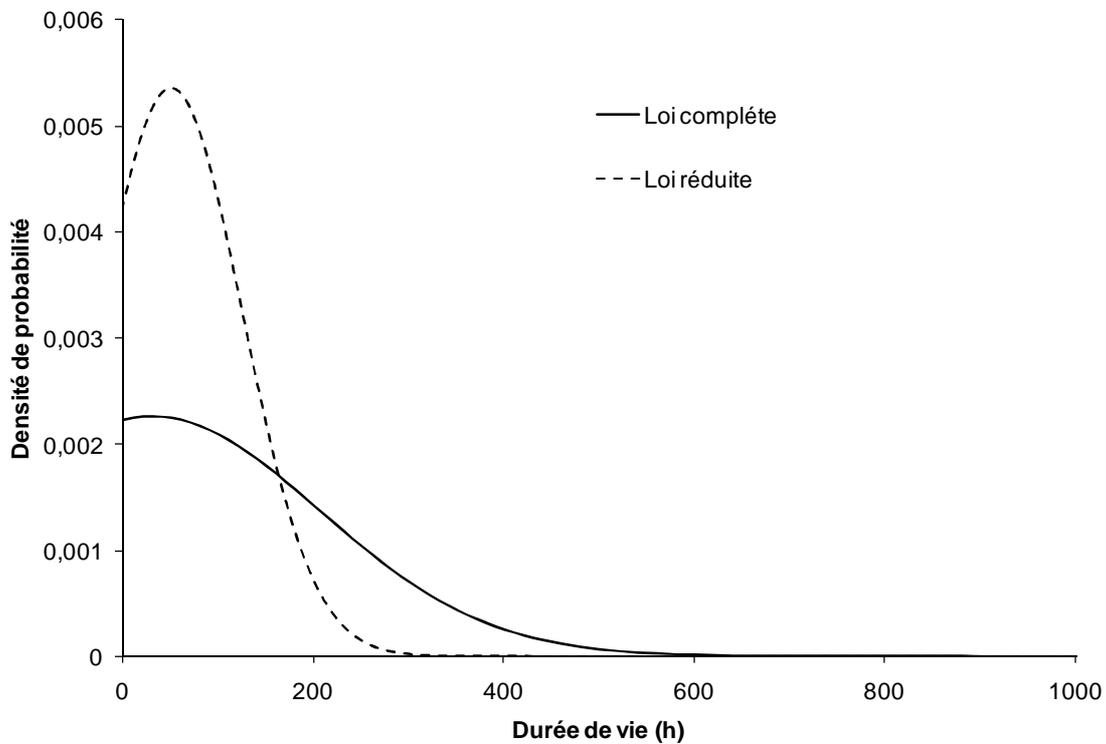
**Figure V – 9 Comparaison des lois de fiabilité réduite et complète sur fil Hi – Nicalon en fatigue statique à 1000MPa - 500°C sous air ambiant. Mise en évidence de l'effet important de l'avis d'expert sur la transformation de la loi réduite.**
