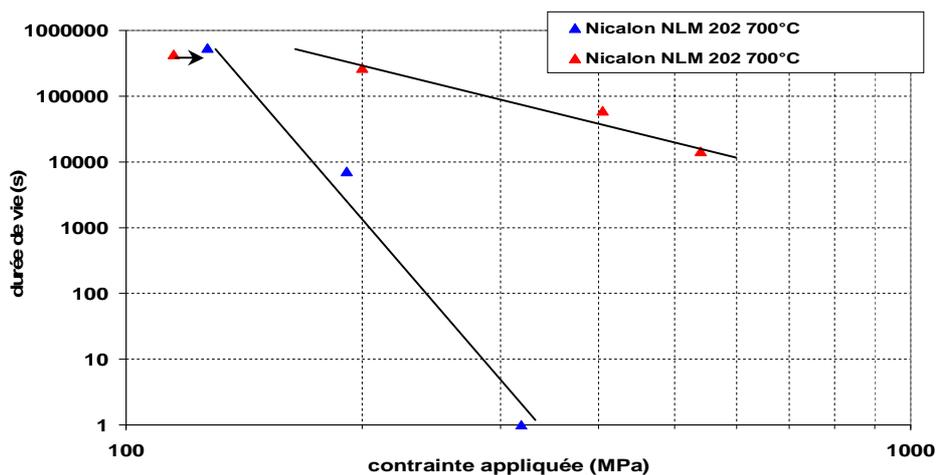
Figure I – 27 Comparaison des résultats de fatigue statique sur fil Nicalon NLM 202 à 700°C [Lavaire1999] [Bertrand1998]
