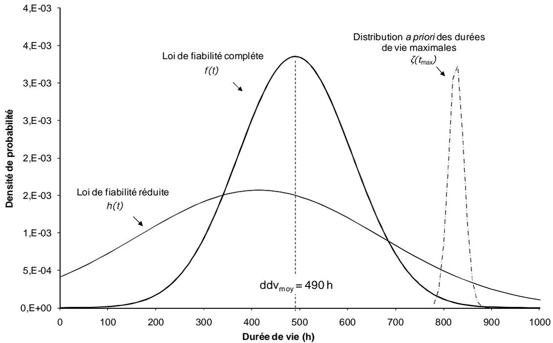
**Figure V – 11 Comparaison de la loi de fiabilité complète et de la loi réduite pour un composite A410 en fatigue statique à 500°C sous air ambiant pour une contrainte efficace de 200MPa en traction uniaxiale. L’avis d’expert est de 800 h pour une probabilité de 99% à 99,9%. Dans la suite, la loi de fiabilité complète sera utilisée pour établir des diagrammes d’endurance sur composite en fatigue à 500°C.**
