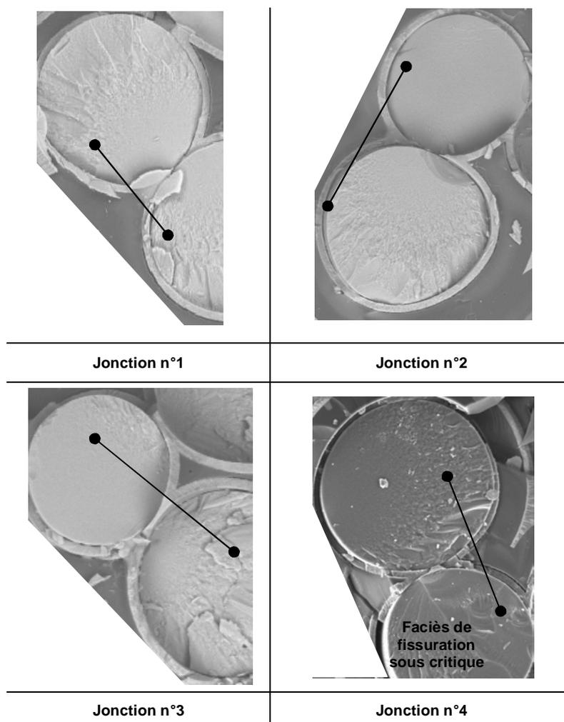
**Figure III – 14** Observation de deux types de jonctions avec les miroirs. La jonction n°1 montre deux miroirs jointifs. Les jonctions n°2 et n°3 montrent des jonctions entre un miroir et un faciès lisse. La jonction n°4 montre une jonction entre un miroir et un faciès de fissuration sous critique.
