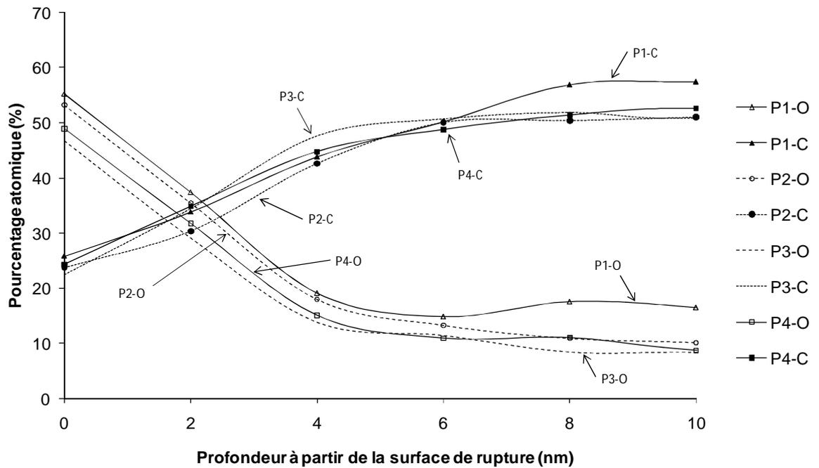
**Figure III – 9** Evolution, en fonction de la profondeur à partir de la surface de rupture, de la concentration en carbone et en oxygène pour différents points du faciès B. Mise en évidence d’un gradient unique de composition. En chaque point, la composition s’enrichit en oxygène et s’appauvrit en carbone lorsque la profondeur diminue.
