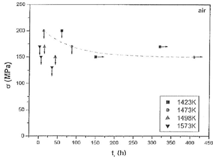
**Figure I – 32** Diagramme d'endurance d'un composite tissé SiC/SiC 2D en fatigue statique sous air à différentes températures. Mise en évidence du phénomène de rupture différée sur composite [Farizy2002].
