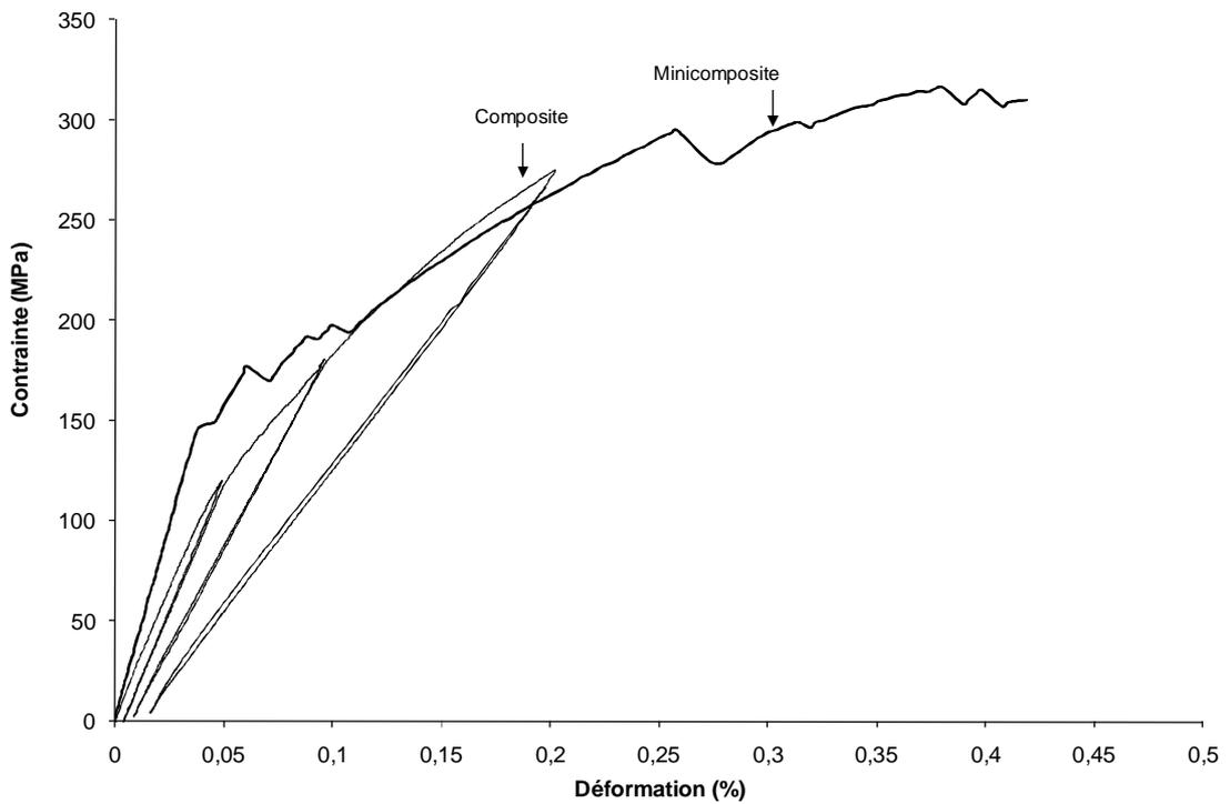
**Figure II – 14 Comparaison entre le comportement du composite et du minicomposite en traction monotone uniaxiale à l'ambiante. Superposition des 2 comportements ce qui démontre que les fils longitudinaux sont assimilables à des minicomposites. Pour le composite, la contrainte est la contrainte efficace.**
