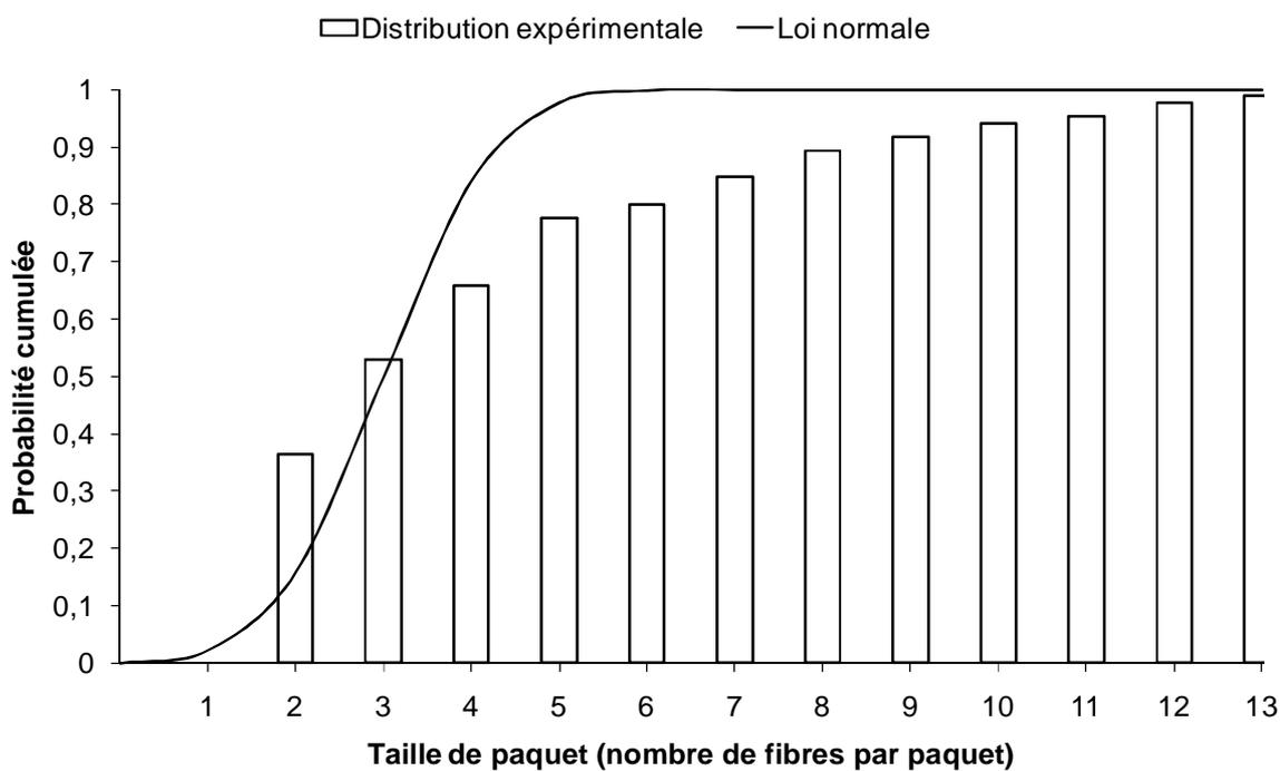
**Figure III – 23** Comparaison entre la distribution statistique expérimentale de la taille des paquets et la loi normale de moyenne 3 et d’écart type 1. Mise en évidence d’une bonne corrélation entre les deux distributions. La taille des paquets est décrite par une loi normale.
