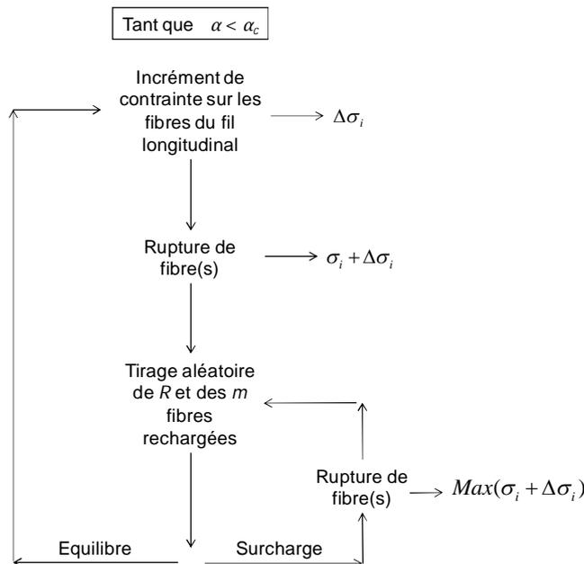
**Figure IV – 7 Description des phases d’endommagement lors d’un essai de traction monotone uniaxiale. Mise en évidence des séquences de tirages aléatoires pour la recharge. Lorsque la fraction critique  $\alpha_c$  de fibres rompues dans le fil longitudinal réel est atteinte, la rupture se produit. La fissuration sous critique est remplacée par une augmentation de contrainte dans les fibres.**
