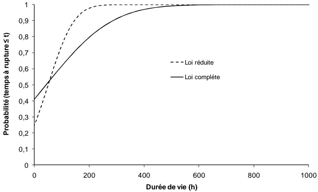
**Figure V – 8 Comparaison des lois de fiabilité réduite et complète intégrée sur fil Hi – Nicalon en fatigue statique à 1000MPa - 500°C sous air ambiant. Mise en évidence de l'effet important de l'avis d'expert sur la transformation de la loi réduite. La loi réduite sous-estime la probabilité de rupture pour les faibles durées de vie (inférieures à 50heures). Au delà de 50 heures, l'ajustement bayésien permet de lever du conservatisme par rapport à la loi réduite.**
