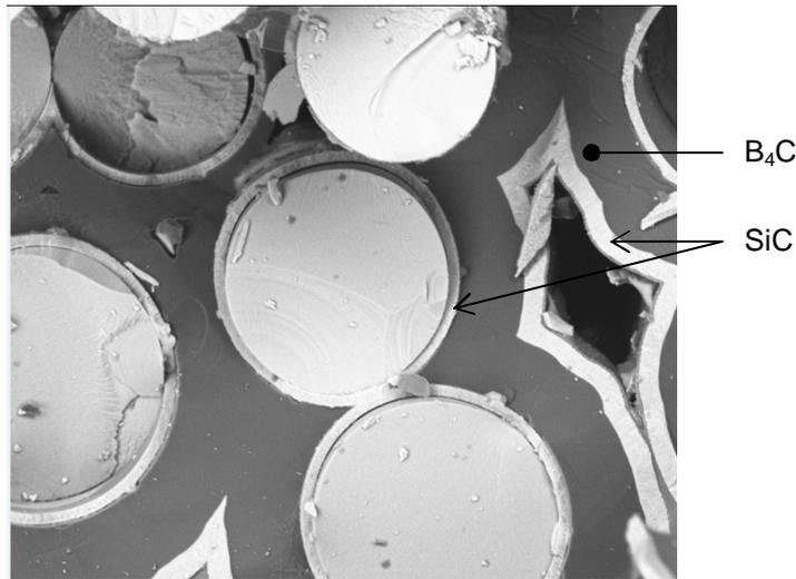
Figure I – 6 Micrographie d'une composite SiC/SiC illustrant les différentes couches de la matrice et le séquençage SiC-B<sub>4</sub>C-SiC.
