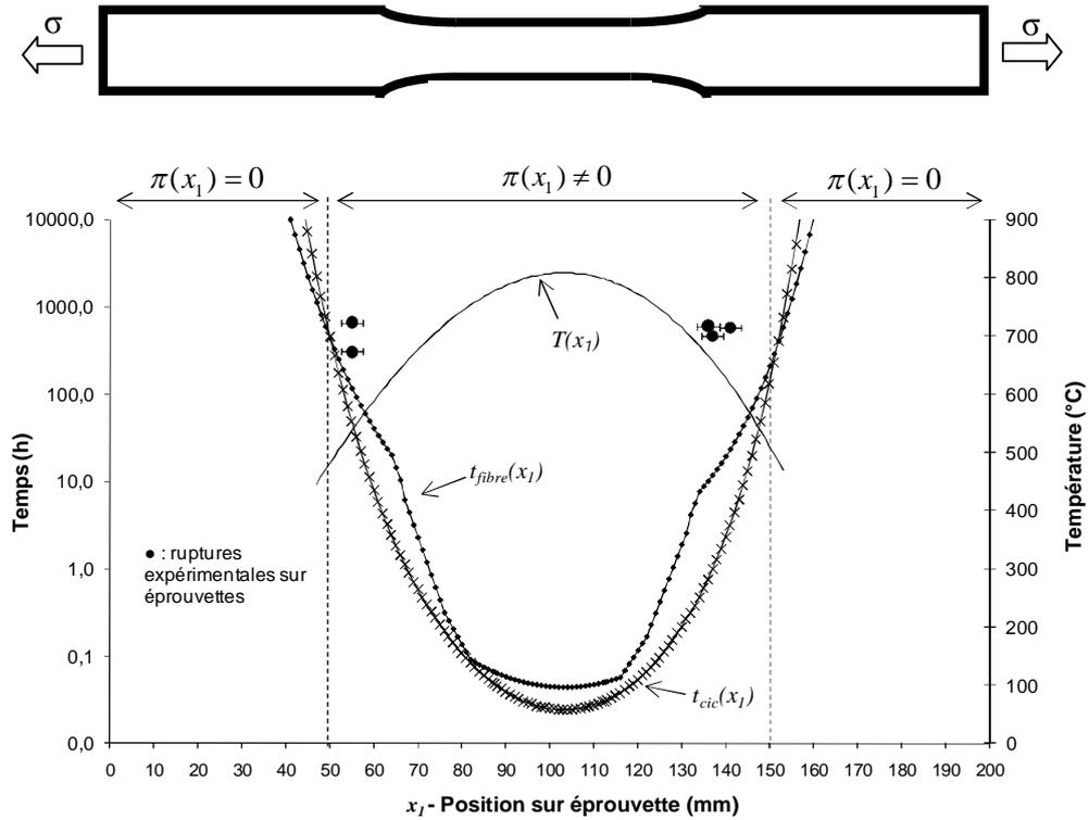
Figure IV – 25 Comparaison entre le temps de cicatrisation  $t_{cic}$  (Eq. IV – 31) et la durée de vie des fibres  $t_{fibre}$  sans effet retard.  $\forall x_1 \in [53 ; 147] \rightarrow T \geq 600^\circ\text{C} \rightarrow$  régime cicatrisant.  $\forall x_1 \in [0 ; 53 [ U ] 147 ; 200] \rightarrow T < 600^\circ\text{C} \rightarrow$  régime non cicatrisant
