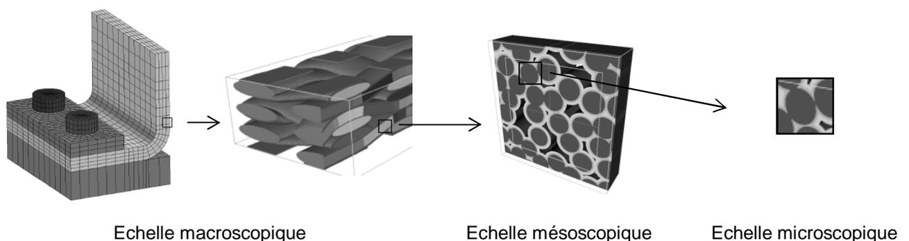
**Figure I – 1** Représentation des différentes échelles du composite <sup>[Couegnat2008]</sup> : section des fibres à l'échelle micro, tissage des fils non imprégné à l'échelle mésoscopique, pièce en composite à l'échelle macroscopique.
