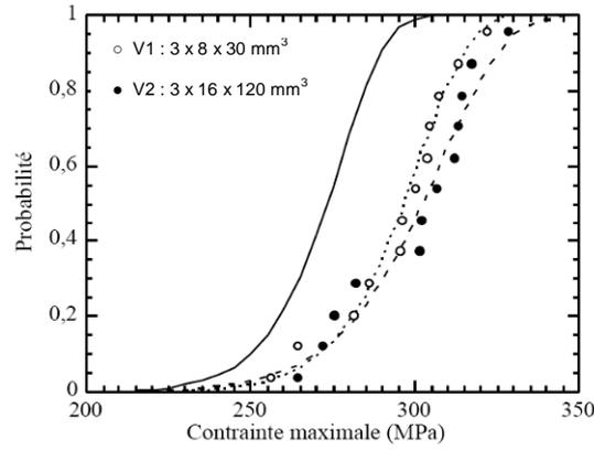
**Figure I – 13 Distributions statistiques des contraintes de rupture de composites 2D SiC/SiC en traction uniaxiale, pour deux lots d'éprouvettes de dimensions différentes [Calard2004]. Mise en évidence de la faible sensibilité de la contrainte de rupture à l'effet de volume.**
