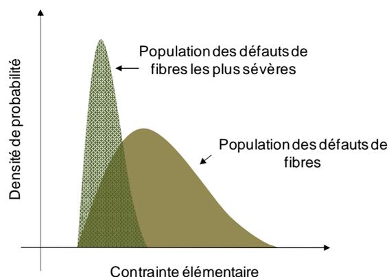
**Figure IV – 1 Représentation des populations de défauts de fibres par les distributions statistiques des contraintes élémentaires : importance des défauts les plus sévères qui fixent la distribution des contraintes de rupture des fibres.**
