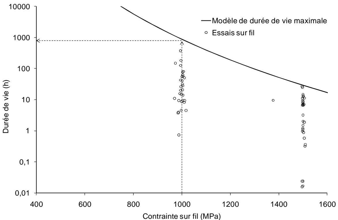
**Figure V – 10 Détermination de l’avis d’expert à partir du modèle de durée de vie sur fil longitudinal. Pour une contrainte sur fil de 1000MPa, la durée de vie maximale correspond à l’avis d’expert. L’avis d’expert est de 800 heures d’après le modèle (Eq. V – 42) [Laforet2009].**
