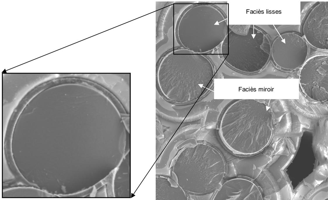
**Figure III – 19** Comparaison entre un faciès lisse et un faciès miroir. Les faciès lisses sont jointifs et dans un plan identique. Mise en évidence de l'absence de défaut et de front d'avancée de fissure sur les faciès lisses.
