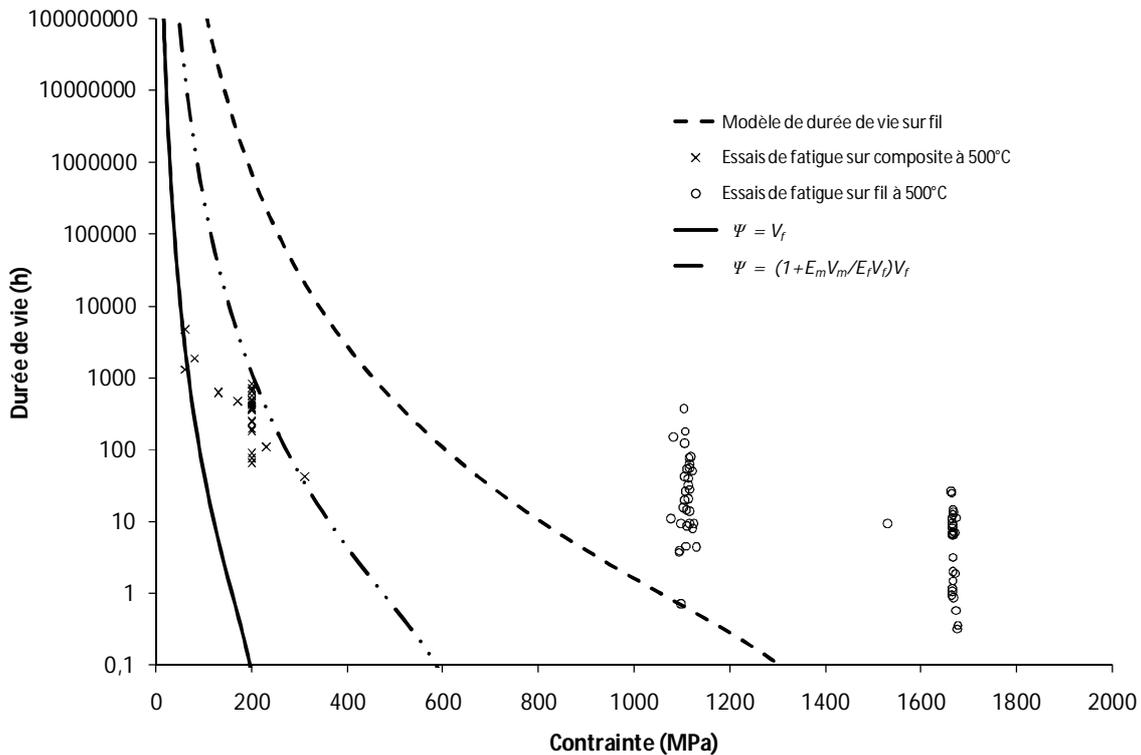
**Figure II – 22 Prédiction des durées de vie 1% sur composite à partir de l'opérateur  $\Psi$  et du modèle de durée de vie sur fil. Fatigue statique à 500°C sous air ambiant. Bonne corrélation entre les prévisions et les durées de vie expérimentales sur composite.**
