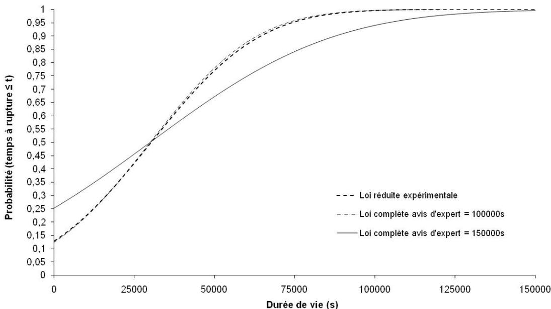
**Figure V – 6** Comparaison des lois de fiabilité réduite et complètes intégrées sur monofilaments Hi – Nicalon en fatigue statique à 1500MPa - 500°C sous air ambiant. Mise en évidence de l’effet important de l’avis d’expert sur la transformation de la loi réduite avec l’avis d’expert à 150000s (47,1 h). La loi réduite et la loi complète sont superposées avec l’avis d’expert à 100000s (27,8 h).
