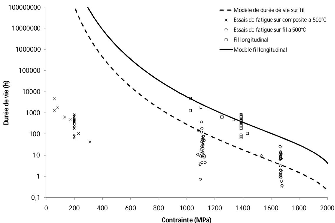
Figure II – 23 Identification du terme retard  $\pi$  dans le domaine non cicatrisant à 500°C sous air ambiant. La contrainte sur composite est la contrainte efficace. La contrainte sur fil longitudinal est calculée par l'opérateur de changement d'échelle.  $\sigma|_{t_r} = \frac{\sigma_c|_{t_r}}{\Psi}$ .  $\Psi$  est donné dans Tableau II – 8. Les durées de vie sur fil sont obtenues par les essais de fatigue statique sous air ambiant à 500°C [Laforet2009].
