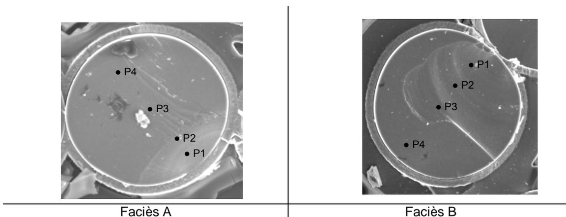
**Figure III – 6** Faciès de rupture de fibre dans différents échantillons après fatigue statique à chaud sous air ambiant destinés aux analyses Auger. Le faciès A s'apparente à un faciès de fissuration sous critique. Le faciès B n'est pas un faciès de fissuration sous critique.
