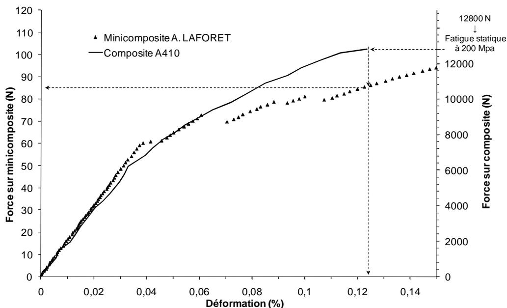
**Figure II – 15** Comparaison du comportement en traction monotone uniaxiale à l’ambiante d’un composite et d’un minicomposite. Pour une contrainte efficace de 200MPa et une déformation de 0,13% sur composite, il faut 150 minicomposites. Or, le composite comporte 150 fils longitudinaux qui supportent intégralement la charge. Ce résultat confirme que les fils longitudinaux dans le composite sont assimilables à des minicomposites.
