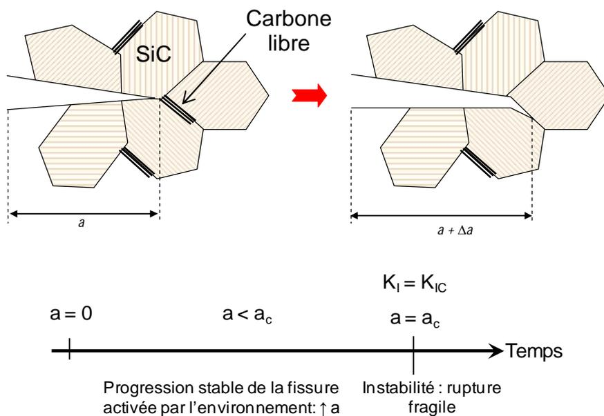
**Figure I – 22** Schématisation du mécanisme de croissance de défaut par fissuration sous critique. Oxydation du carbone libre aux joints de grains de SiC en pointe de fissure <sup>[Gauthier2007]</sup>.
