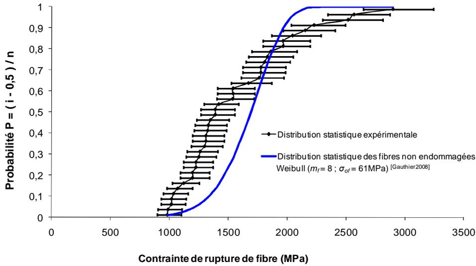
**Figure III – 17 Comparaison entre la distribution statistique expérimentale des contraintes de rupture de fibres et la distribution théorique des contraintes de rupture des fibres à l’ambiante. La distribution théorique est une loi de Weibull et correspond aux fibres non endommagées [Gauthier2008]. La distribution expérimentale est calculée à partir de la taille des miroirs. Une bonne corrélation est observée entre les deux distributions.**
