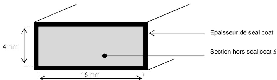
**Figure II – 9** Représentation idéalisée d'une section de l'éprouvette avec la présence de seal coat d'épaisseur constante. En réalité, l'épaisseur est variable.
