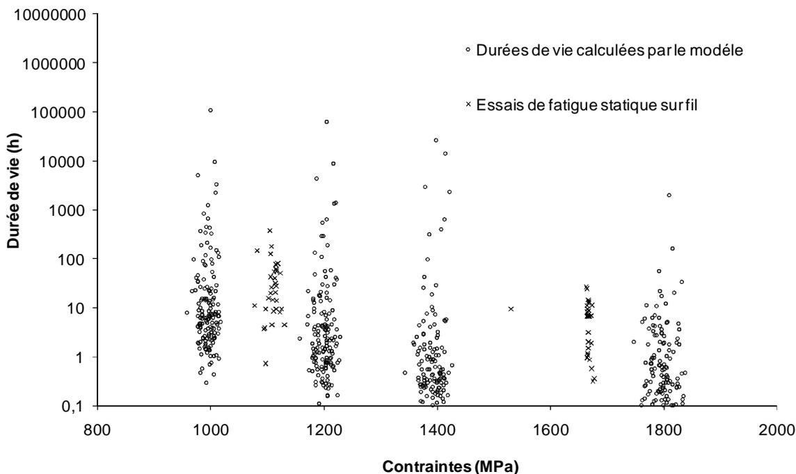
**Figure IV – 9** Comparaison des durées de vie expérimentales sur fil seul [Laforet2009] en fatigue statique à 500°C à 1000MPa et 1500MPa avec les durées de vie calculées par le modèle (150 simulations par contrainte). Dans le modèle, le taux de fibres jointives et l'effet retard de la matrice sont nuls. La microstructure est identique pour toutes les simulations. Bonne corrélation observée entre résultats numériques et expérimentaux.
