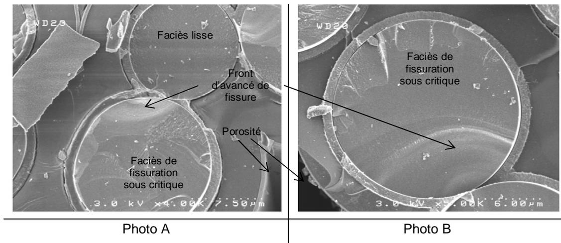
**Figure III – 2 Observation de faciès de fissuration sous critique sur différents échantillons. Présence de porosité au voisinage des faciès de fissuration sous critique. Photo A : présence de faciès lisses en contact avec un faciès de fissuration sous critique. Photo B : présence d'un contact entre le faciès de fissuration sous critique et un autre faciès.**
