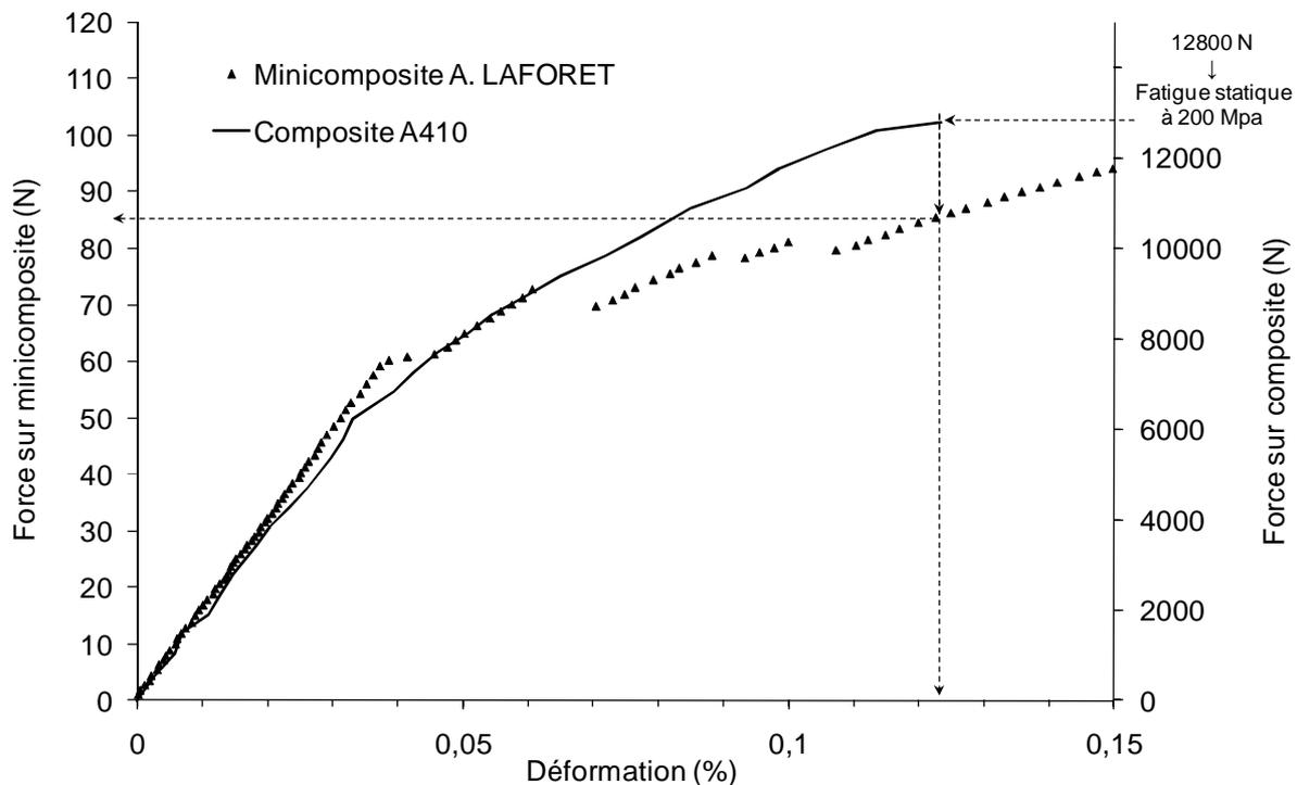
**Figure IV – 2** Courbes de traction monotone sur composite et minicomposite à température ambiante. Illustration du raisonnement à déformation constante pour déduire la force sur fil longitudinal  $F_f(\varepsilon)$  à partir de la force appliquée au composite en fatigue à 200MPa (soit 12800N en traction uniaxiale).
