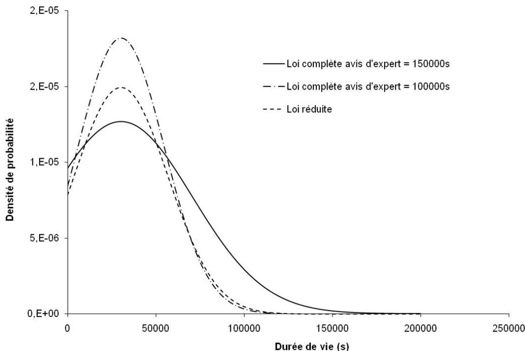
**Figure V – 7** Comparaison des lois de fiabilité réduite et complètes sur monofilaments Hi – Nicalon en fatigue statique à 1500MPa - 500°C sous air ambiant. Mise en évidence de l’effet important de l’avis d’expert sur la transformation de la loi réduite avec l’avis d’expert à 150000s (47,1 h). La loi réduite et la loi complète sont superposées avec l’avis d’expert à 100000s (27,8 h).
