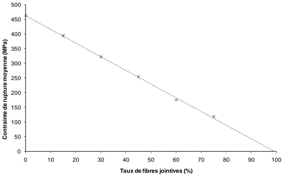
Figure IV – 20 Effet du taux de fibre jointives sur la durée de vie moyenne du composite calculée par le modèle mécanique probabiliste. Fatigue statique à 500°C et 200MPa. La durée de vie est la durée de vie de fil longitudinal.
