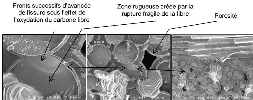
**Figure III – 3** *Faciès de fissuration sous critique observé sur une micrographie du composite réalisée par microscopie électronique à balayage (MEB). Rupture après 109 h de fatigue à 500°C et 133MPa. Présence de la fissuration sous critique en périphérie de fil longitudinal et à proximité d'une porosité.*
