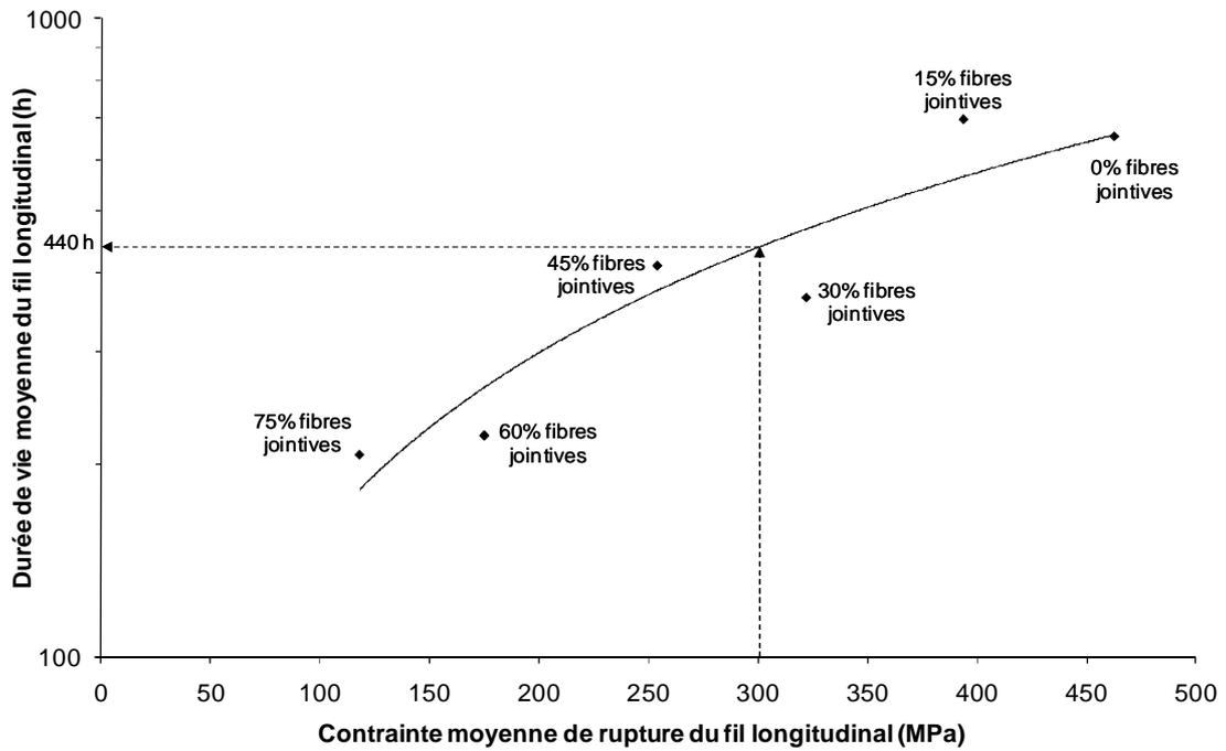
**Figure IV – 21 Evolution de la durée de vie moyenne du fil longitudinal et de sa contrainte de rupture en fonction du taux de fibres jointives. Lorsque le taux de fibres jointives augmente, la durée de vie et la contrainte de rupture diminuent. Mise en évidence d’une corrélation entre durée de vie et contrainte de rupture basée sur la microstructure.**
