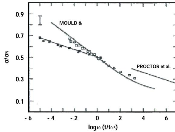
Figure I – 19 Courbes de durée de vie après essais de fatigue statique sur différents verres silicatés [Wiederhorn1970]
