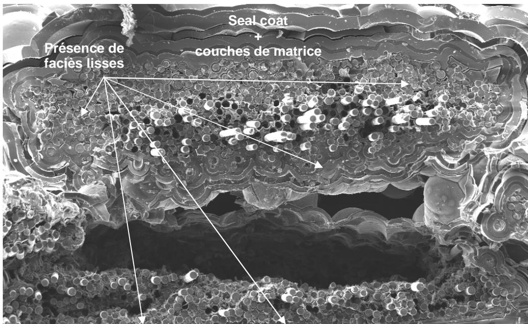
**Figure III – 20** Micrographie illustrant la corrélation entre la présence de faciès lisses et de zones peu chahutées (absence de foisonnement). Les faciès lisses sont dans un plan identique et leur position est aussi bien en périphérie de fil longitudinal qu'au centre. Pas d'influence observable des couches de matrice sur la densité de faciès lisses.
