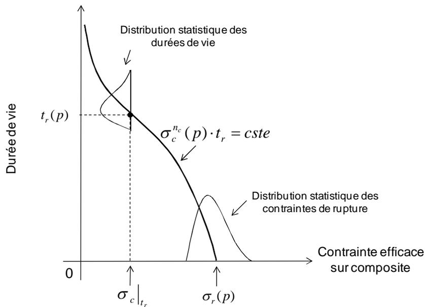
**Figure IV – 22 Principe de la prévision de la durée de vie en fatigue à partir d’un essai de traction monotone. Méthode de prévision basée sur la corrélation entre dispersion de la contrainte à rupture et dispersion de la durée de vie. La prévision est établie sur le modèle de durée de vie exprimé par une loi puissance.**
