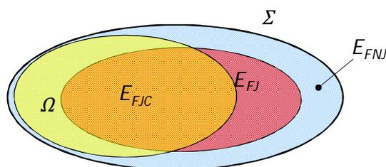
**Figure III – 11 Représentation de l'augmentation de l'ensemble  $\Omega$  lors du passage du régime composite au régime fil. La quantité de fibres exposées à l'oxygène augmente car la fissuration matricielle se développe.**
