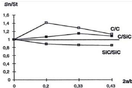
**Figure I – 11** Sensibilité à l'effet d'entaille de composites à renfort tissé et matrice carbone ou céramique (SiC) mesurée sur des éprouvettes de traction uniaxiale.  $S_n/S_t$  est le rapport des contraintes de rupture d'une éprouvette entaillée et d'une éprouvette non entaillée :  $a$  est la longueur de chaque entaille et  $b$  la largeur de l'éprouvette [Lamon2005].
