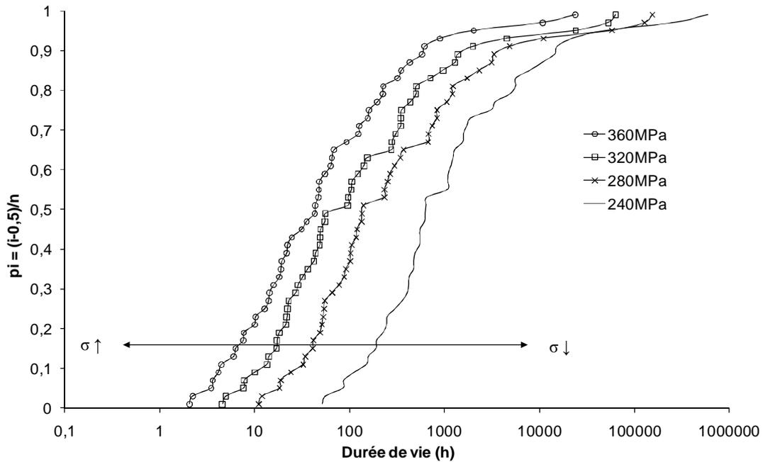
**Figure IV – 10 Décalage de la distribution des durées de vie du fil longitudinal vers les faibles valeurs sous l’effet de l’augmentation de la contrainte efficace. Résultats obtenus par le modèle en fatigue statique en traction, à 500°C, 200MPa sous air ambiant. Taux de fibres jointives de 30%, la microstructure est identique pour toutes les simulations.**
