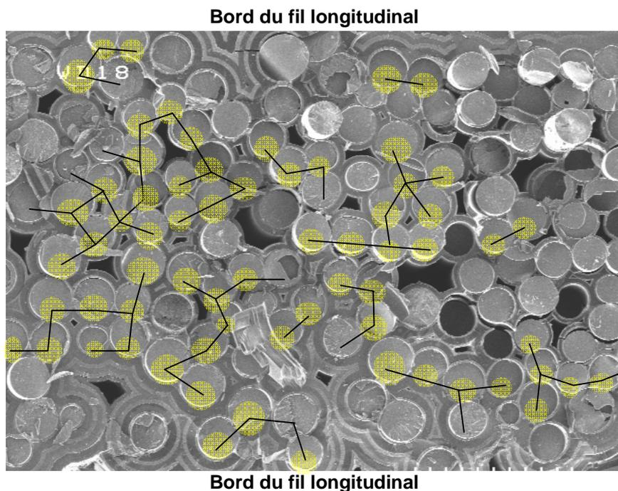
**Figure III – 21** Micrographie d'une section de fil longitudinal illustrant la présence de faciès lisses (colorés en jaunes). Les traits noirs indiquent le réseau de jonctions entre les faciès lisses qui forment des paquets. Certains faciès lisses sont jointifs avec un miroir dans certains paquets. La taille, la disposition et l'arrangement des paquets sont aléatoires. Pas de présence préférentielle des faciès lisses entre le bord et le cœur du fil longitudinal.
