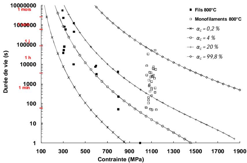
Figure I – 34 Prévisions de la durée de vie sur fibre et fil Hi-Nicalon à partir du modèle de fissuration sous critique et pour différentes valeurs de  $\alpha_c$ . Comparaison des prévisions aux durées de vie obtenues par les essais de fatigue statique à 800°C [Gauthier2008].
