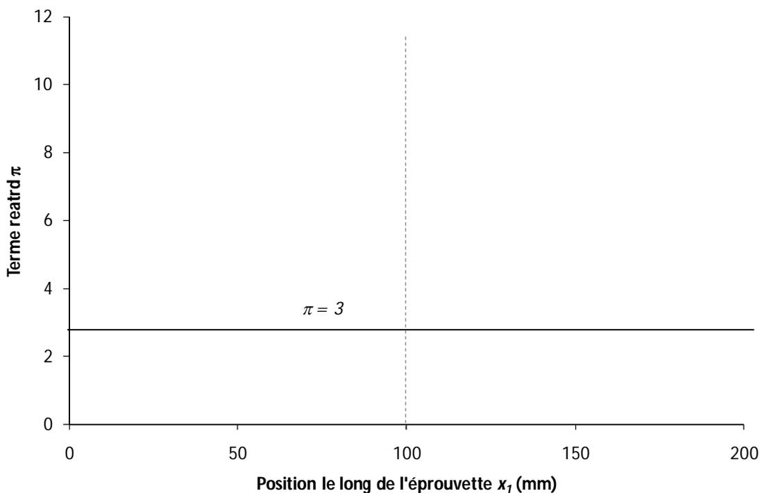
Figure II – 25 Evolution du terme retard le long de l'éprouvette lors des essais de fatigue statique à 500°C. La cicatrisation matricielle n'est pas activée.
