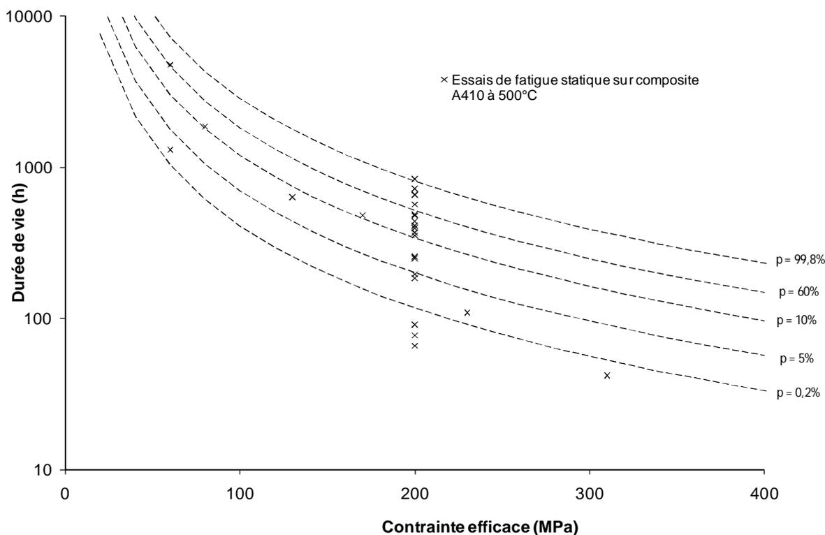
**Figure V – 14 Spectre des courbes d'endurance pour un composite en fatigue statique en traction uniaxiale à 500°C sous air ambiant. Prédiction de la durée de vie en fonction de la contrainte efficace et de la probabilité de rupture. Encadrement satisfaisant des durées de vie expérimentales par les prévisions.**
