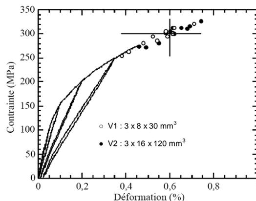
**Figure I – 12** Courbes de comportement en traction uniaxiale de composites 2D-SiC/SiC, obtenues pour 2 lots d'éprouvettes de dimensions différentes. Les points en fin d'essai représentent les contraintes maximales atteintes pour les différentes éprouvettes <sup>[Lamon2005]</sup>.
