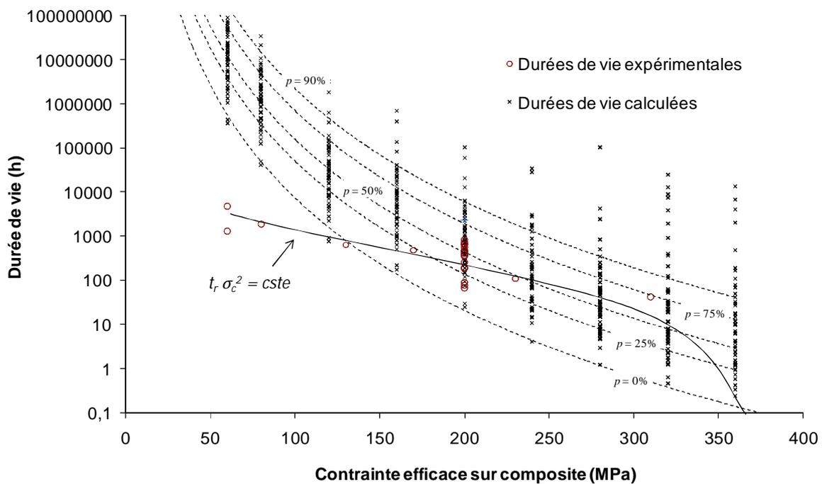
Figure IV – 13 Graphique Strength Probability Time sur fil longitudinal construit à partir du modèle mécanique probabiliste. Fatigue statique à 500°C sous air ambiant. En pointillés, les courbes d'endurance calculées par le modèle. En trait plein, la régression des durées de vie expérimentales sur composite en fatigue. Bonne corrélation entre prévisions et résultats expérimentaux.
