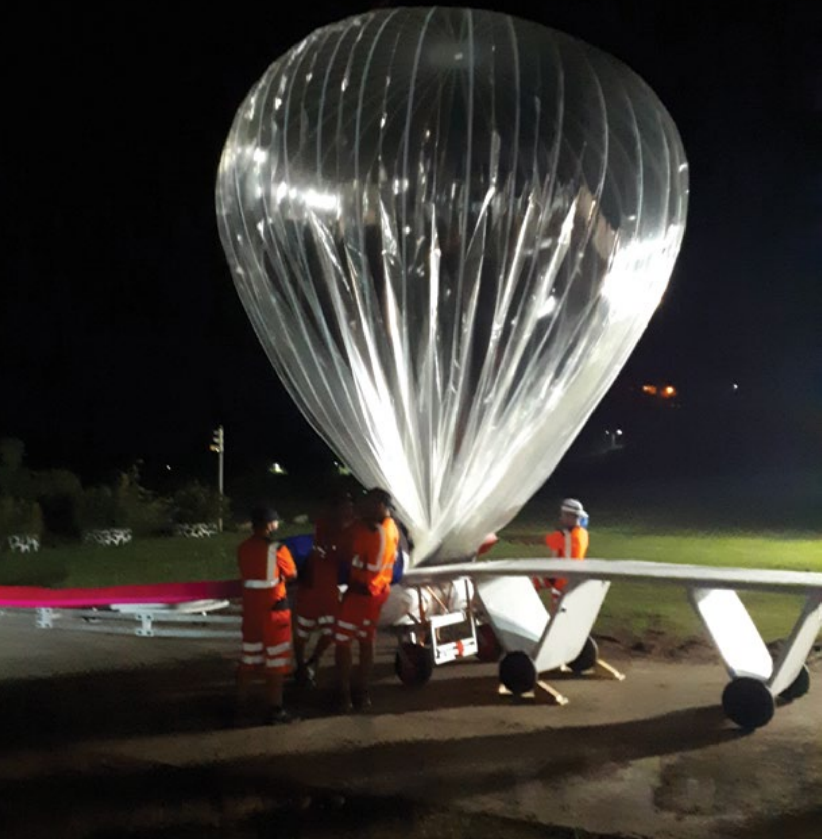
Préparation de lâcher d'un ballon pressurisé depuis l'aéroport des Seychelles, lors de la première campagne Stratéole 2, novembre-décembre 2019. Le ballon est gonflé avec une masse précise d'hélium et il deviendra sphérique lors de son ascension. Une fois qu'il a atteint son plafond (entre 18 et 20 km), la surpression interne le maintient sphérique, l'enveloppe inextensible fait qu'il conserve son volume et il dérive donc comme une parcelle qui conserve sa masse volumique (trajectoire isopycne).
